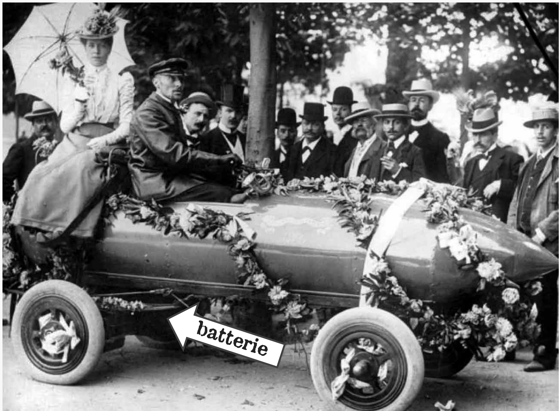
Camille Jenatzy ( Le Diable Rouge ) et sa femme en 1899 aux Tuileries lors de la célébration du record établi avec La Jamais Contente (106 km/h). La voiture était alimentée par une batterie au plomb, faite des 100 accumulateurs ( 100 \times 2 \text{ V} = 200 \text{ V} )
