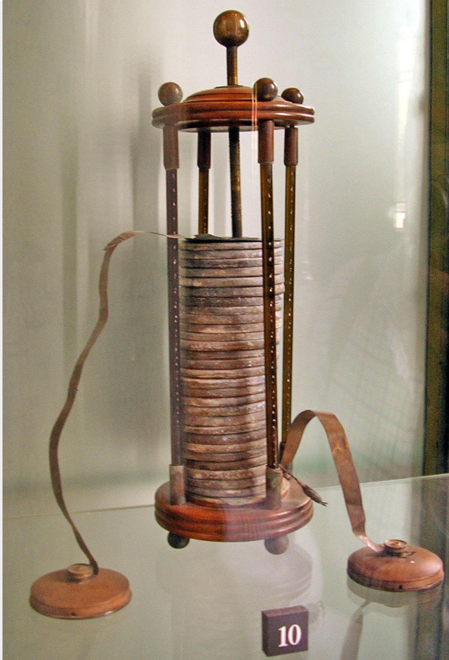
La pila di Volta (1799) (versione Rame/Zinco) in esposizione presso il Tempio Voltiano, Como
